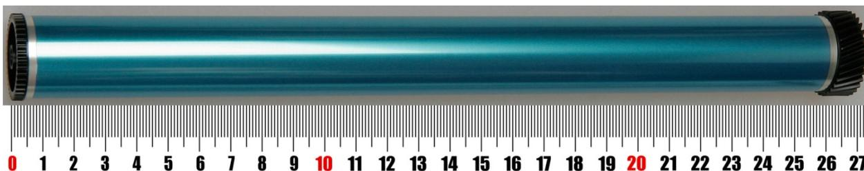
3. Покрытие на барабане прозрачное (свет отражается от алюминиевой поверхности барабана), это покрытие имеет при обычном освещении зелено-голубые оттенки. Общая длина барабана 260 мм.
